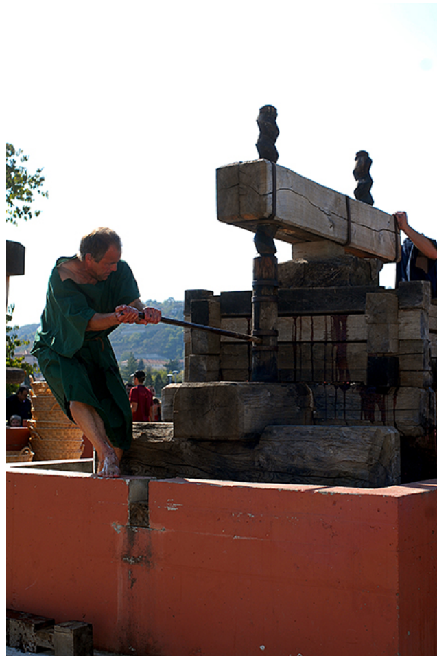
III. 5 : Pressurage du raisin avec un pressoir à double vis reconstitué, Vinalia 2009. © Paul Veyseyre, Musée gallo-romain de Saint-Romain-en-Gal – Vienne.
