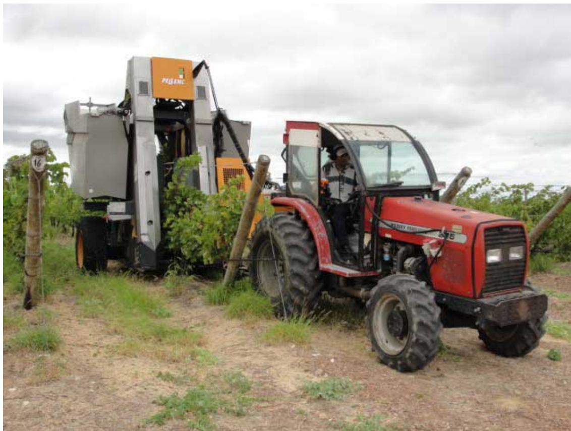
Figura 4. Colheita mecânica de uva Chenin Blanc em empresa vinícola localizada no município de Casa Nova – BA.
