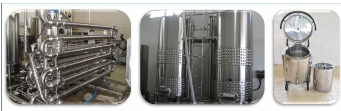
Figure 4. Équipement utilisé pour l'élaboration du jus de raisin, par réchauffement : Photo 1 - Tuyauterie d'extraction et d'élaboration du jus, avec circulation du raisin dans la tuyauterie et séparation ultérieure par des esgotadores (tami-seurs) ; Photo 2 - Cuve verticale d'extraction et d'élaboration du jus, avec raisins statiques et pompage externe du jus pendant l'extraction ; et, Photo 3 - Suquificateur , nouvel équipement pour l'élaboration de jus de raisin entier en petits volumes.
