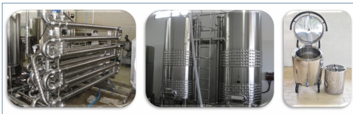
Figure 4. Équipement utilisé pour l'élaboration du jus de raisin, par réchauffement : Photo 1 - Tuyauterie d'extraction et d'élaboration du jus, avec circulation du raisin dans la tuyauterie et séparation ultérieure par des esgotadores (tamis-seurs) ; Photo 2 - Cuve verticale d'extraction et d'élaboration du jus, avec raisins statiques et pompage externe du jus pendant l'extraction ; et, Photo 3 - Suquificateur , nouvel équipement pour l'élaboration de jus de raisin entier en petits volumes.
