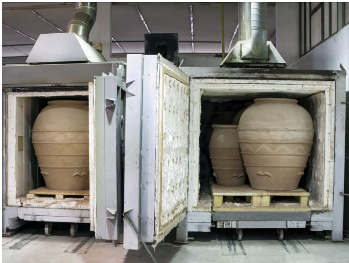
Photo n°13 : Vue des fours de cuisson des jarres dans l'atelier Artenova . © Artenova .
