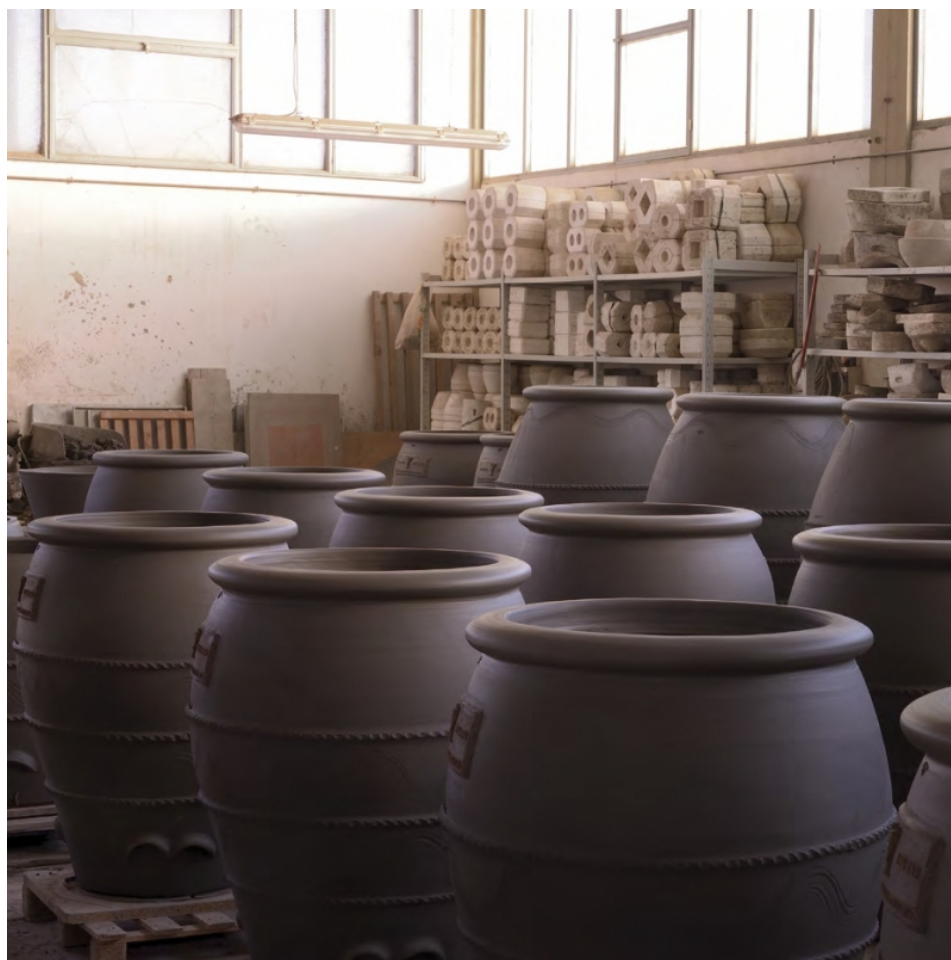
Photo n°12 : Les pièces, une fois façonnées, exigent un séchage progressif de plusieurs semaines. © Artenova.
