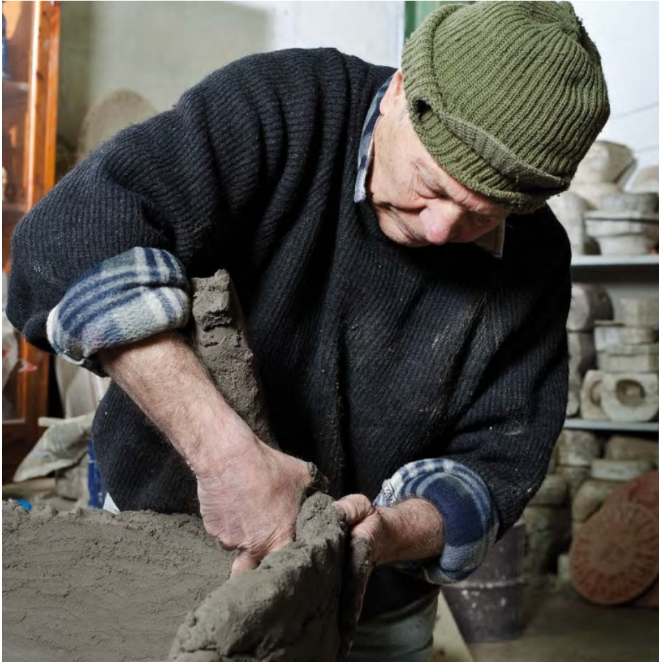
Fotografia n°11: nell'atelier Artenova la fabbricazione di anfore è realizzata secondo la tradizionale tecnica a cercine.
