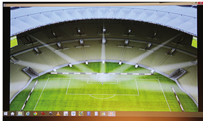
Figure n° 1 : Le système de triangulation de la Goal Line Technology (GLT).
