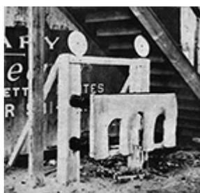
Ce joug rembourré est muni de deux dynamomètres qui mesurent simultanément la poussée à droite et à gauche.
